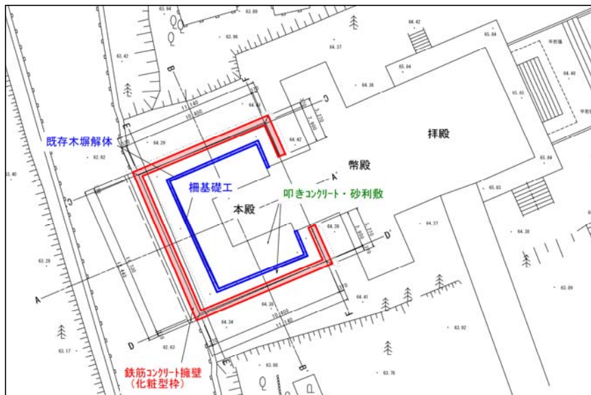
本殿盛土基礎擁壁工(完成平面図)
